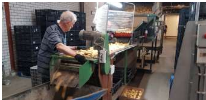
Foto 2. De Inpaklijn voor de aardappelen in werking met op de foto de sorteerbands om "kneusjes" eruit te halen.
